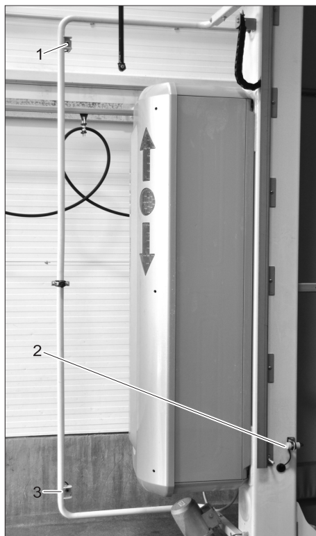
Obr. 2 1 Světelná závora poloha 2 nahoře 2 Koncový spínač střešního kartáče dole (SKD) 3 Světelná závora poloha 2 dole
