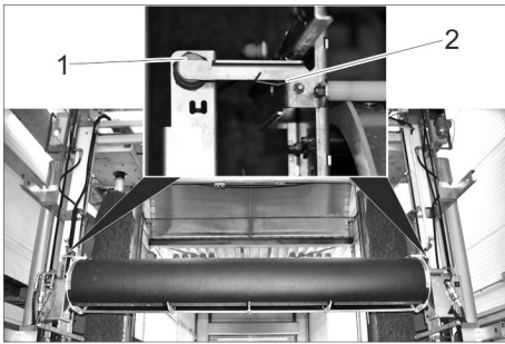
Joonis 8 1 Lõpplüüti turvalüüti kõrgsurve-katusetala 2 Vedru
