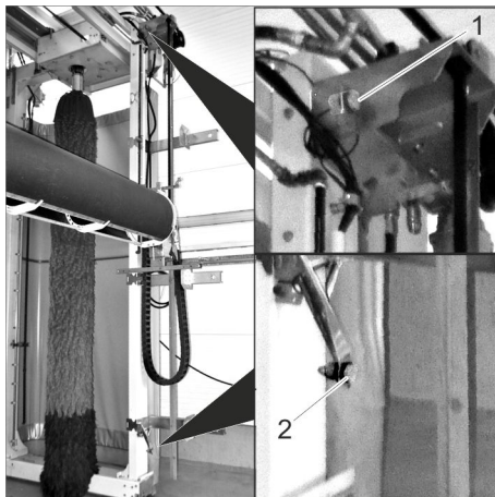
Obr. 7 1 Koncový spínač vysokotlaké střešní lišty nahoře (HdO) 2 Koncový spínač vysokotlaká střešní lišta dole (HdU)
